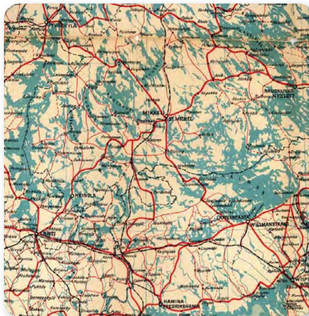
Kuva 12. Tässä varhaisessa autoilijan tiekartassa Por- rasalmen tie on osa maantieyhteyttä Mikkeli – Lappeen- ranta. Tien kuvaajan paksu viiva osoittaa, että tie on luoki- teltu valtakunnalliseen maanteiden kaukoyhteysverkkoon eli kaupunkien väliseen liikenteeseen.
